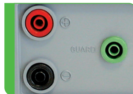
Guard pripojovací terminál pre elimináciu vplyvu povrchových prúdov.
