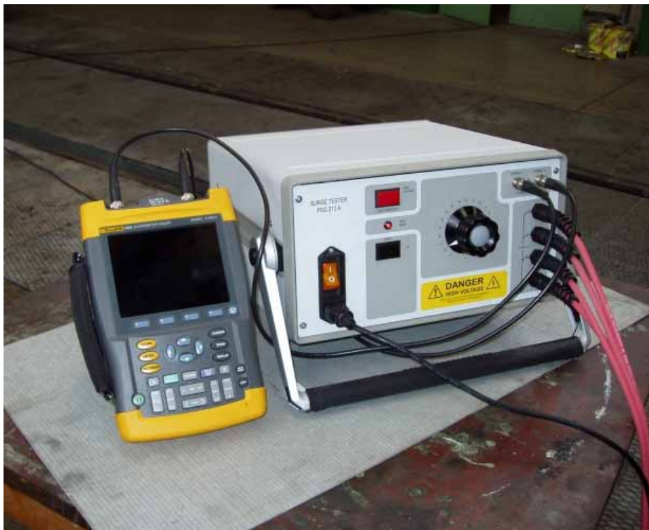
Rázový generátor řady PSG212A a osciloskop Fluke 199C/S, měření Žilina
