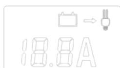
vybíjacím prúdom od batérie k záťaži
