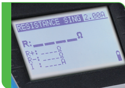
Veľký analógovo / digitálny LCD displej s podsvietením
