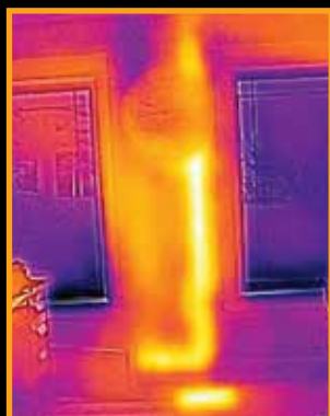
Detekce teplovodního potrubí ve stěně
