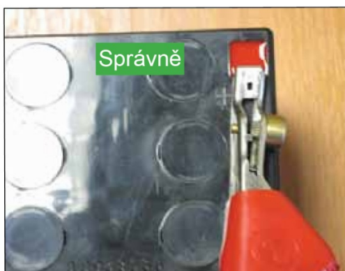
Nacvakněte svorky pevně na ploché vývody
