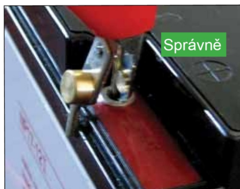
Zatlačte svorky pevně do vývodů baterie
