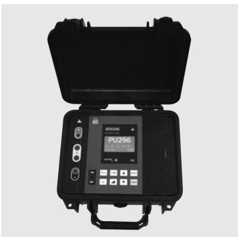
PU296 je konstruován v plastovém kufru PELI. Měřené hodnoty lze odečítat na grafickém podsvíceném displeji a ukládat do paměti přístroje. Ty lze přenést přes USB port do PC k dalšímu zpracování. Součástí dodávky je i pár speciálních měřicích šňůr. Všechny funkce lze ovládat z membránové klávesnice. Napájení zajišťuje olověný akumulátor, který je možné dobýt vestavěnou nabíječkou.
