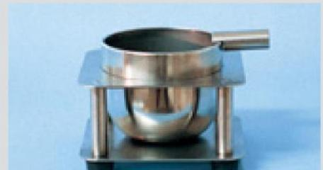
Elektrolytický pohárek pro měření drátů a malých částí.
