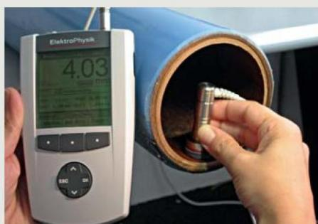
Drsné prostředí, jako jsou prachové částice, nebo znečištění barvou, vyžaduje sondy v odolnějším provedení. Pro zajištění nejvyšší ochrany, splňující vaše požadavky měření v drsném prostředí, nabízí MiniTest sérije 7400 speciální řadu sond HD. Tyto sondy pro vysoké zatížení obsahují speciální těsnění spár k ochraně elektroniky. Pro usnadnění čištění jsou sondy vybaveny montážním systémem s vnějšími pružinami.
