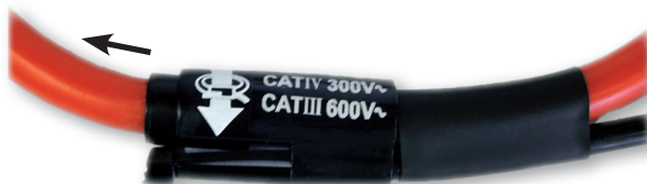
Vytažení volného konce smyčky snímače
