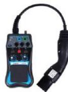
Adaptér A 1532 EVSE XA slúži na overenie elektrickej bezpečnosti a funkčné testovanie EVSE spolu s podporovanými inštalačnými testerami METREL. Je určený na testovanie napájacieho zariadenia Mode 3 s konektorom typu 2. Verzia XA podporuje 3-fázové testovanie záťaže až do 13 A a rôzne typy chýb, vrátane prerušeného PE.
