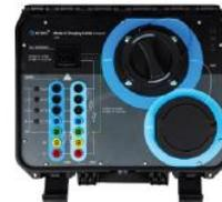
Adaptér je určený na overenie elektrickej bezpečnosti nabíjajúcich káblov Mode 3 EV s konektormi typu 2.
