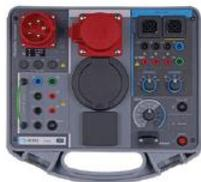
A 1632 eMobility Analyzer je určený na diagnostické testovanie nabíjačiek elektrických vozidiel (EVSE) spolu s podporovanými inštalačnými testerami METREL. Podporuje overenie elektrickej bezpečnosti a funkčné testovanie EVSE typu 1 a typu 2, ako aj testovanie nabíjajúcich káblov Mode 2 a Mode 3, a tiež monitorovanie komunikácie medzi nabíjacou stanicou a EV počas nabíjania.
