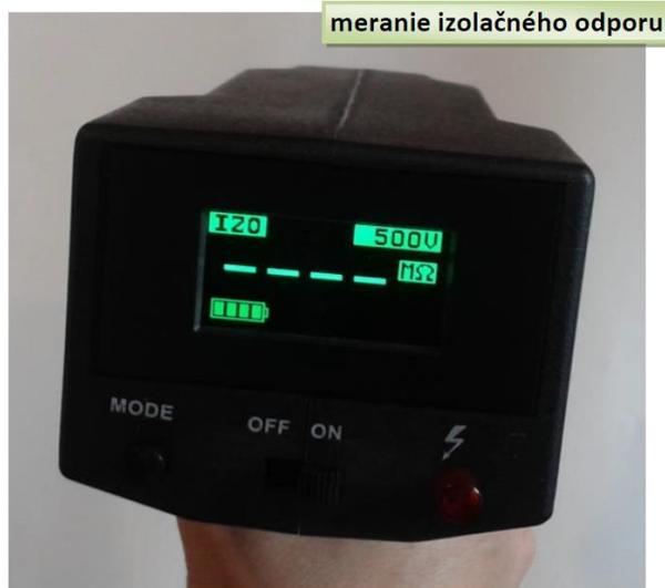
meranie izolačného odporu
