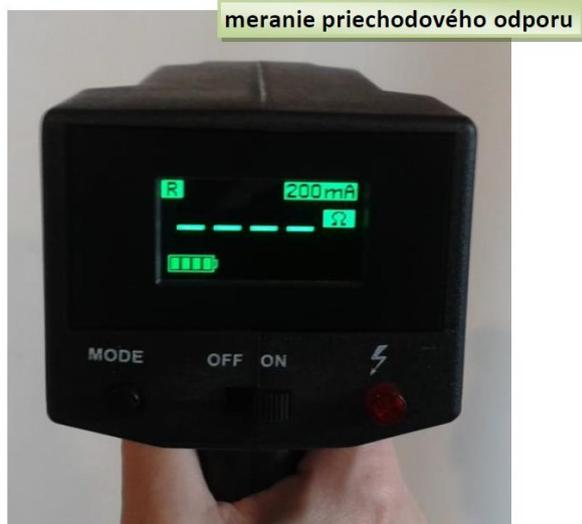
meranie prechodového odporu
