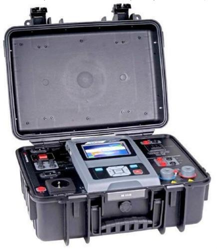
MultiServicerXD je multifunkčný prístroj určený pre použitie v priemysle, kde odolnosť a spoľahlivosť sú nevyhnutnosťou. Prístroj je vybavený farebným dotykovým displejom, zdokonaleným organizérom pamäte a funkciou automatických postupností testovania AUTOSEQUENCE®.
